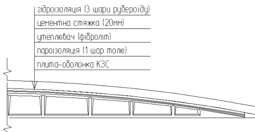
Рис.1.2. Конструкція плити-оболонки покриття спортивного корпусу
