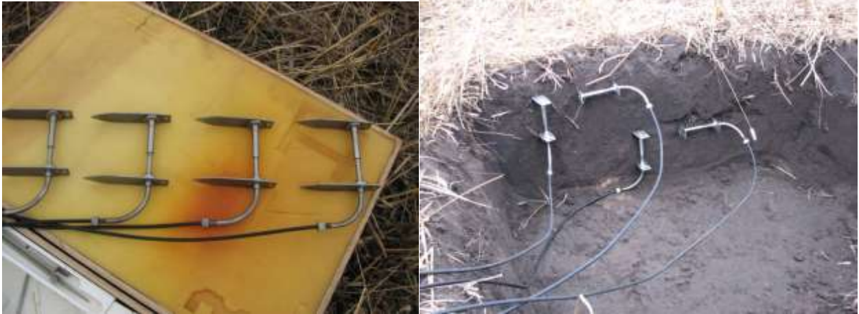
Рис. 10. Загальний вигляд датчиків переміщення ґрунту приладу УРДП-АФІ та загальний вигляд виритої траншеї зі встановленими датчиками переміщення ґрунту приладу УРДП-АФІ
