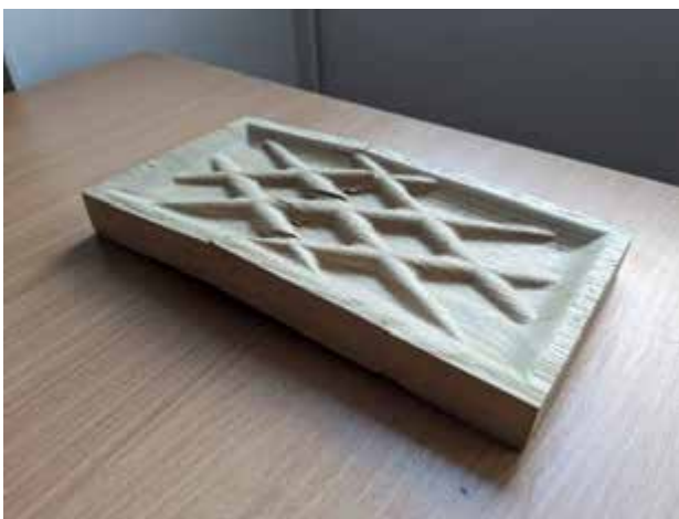
Рисунок 3.3. Зруйнований зразок діагонального фрезерування з двох сторін
