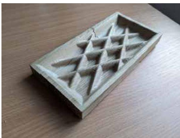
Рисунок 3.2. Зруйнований зразок діагонального фрезерування
