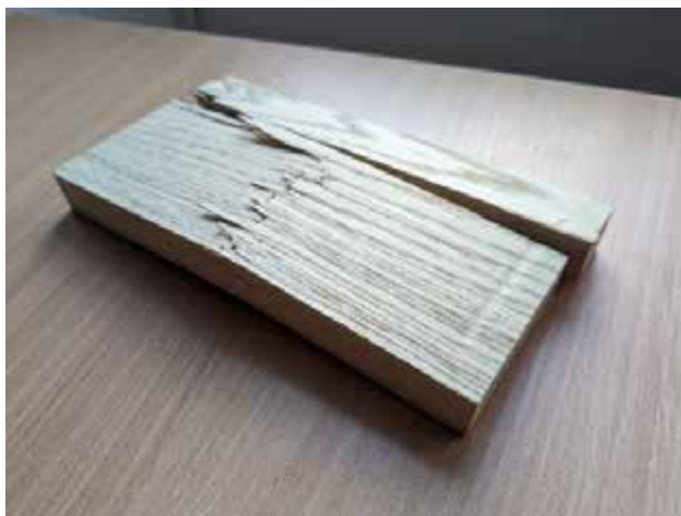
Рисунок 3.1. Зруйнований цільний зразок
