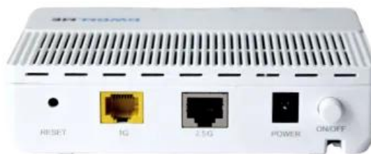
Рис. 4.22. Абонентський пристрій ONU (з підтримкою WiFi) виробництва компанії DWDM.ME модель XGPON XGP-1+2.5.
