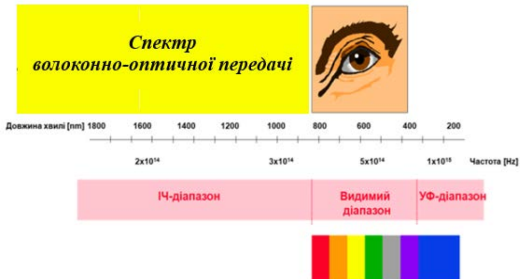
Рис. 1.6. Довжин хвиль, які використовуються у волоконно-оптичній передачі.
