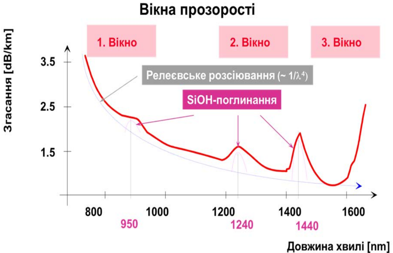
Рис. 2.3. Характеристика згасання оптичного волокна (вікна прозорості оптичного волокна)
