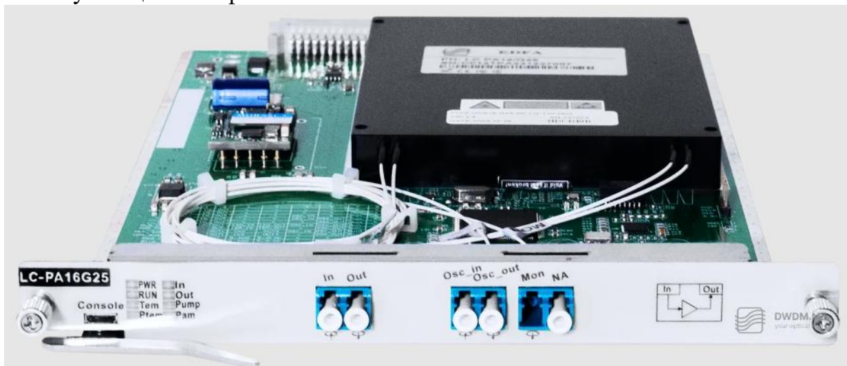
Рис. 4.6. Оптичний підсилювач EDFA компанії DWDM.ME.
