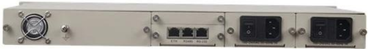
Рис. 4.10. Розподілений раманівський підсилювач (DRA) компанії DWDM.ME.
