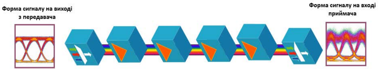
Рис. 2.4. Деформація сигналу при передачі на велику відстань.
