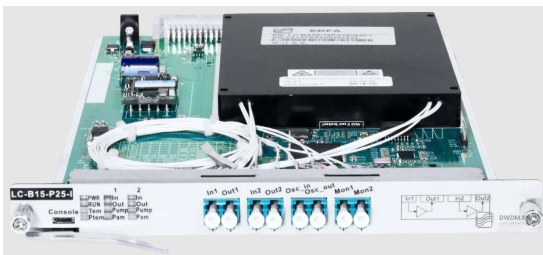
Рис. 4.7. Подвійний оптичний підсилювач EDFA компанії DWDM.ME.
