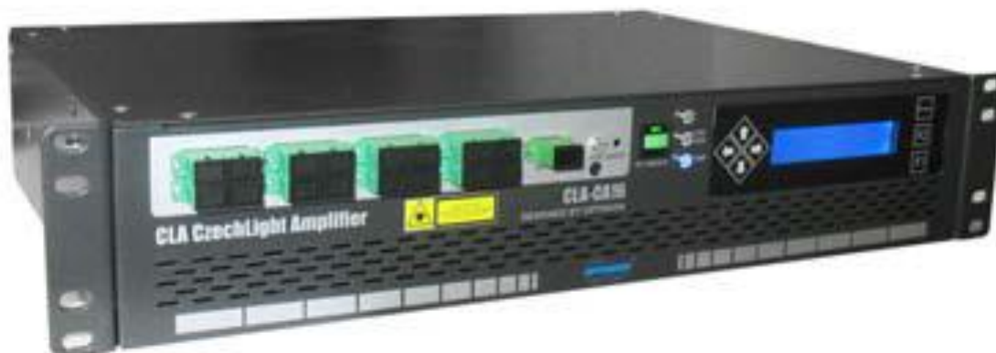
Рис. 4.3. EDFA-підсилювач чеської компанії Optokon.
