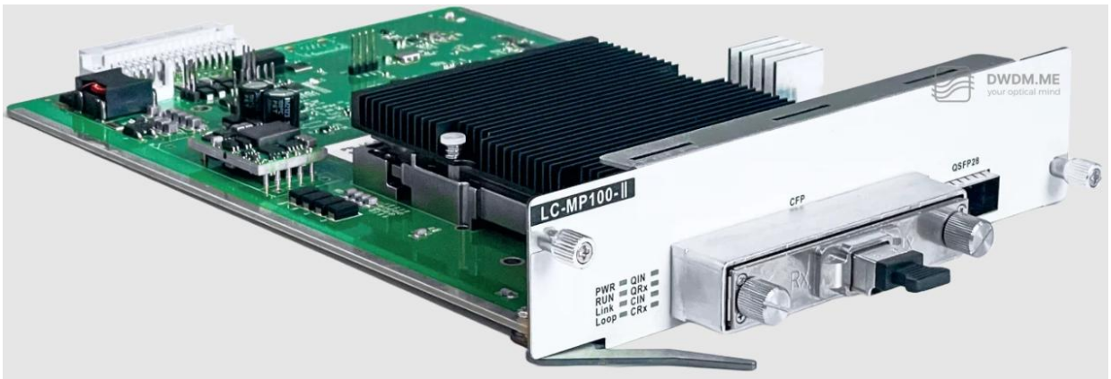
Рис. 6.9. Транспондер LC-MP100-II - 100G (QSFP28 to CFP-DCO) компанії DWDM.ME.
