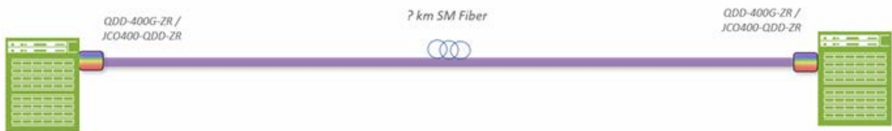
Рис. 2.15. Одноканальний нелінійний (без підсилювачів) оптичний лінк (лінія зв'язку) з використанням модулів QDD-400G-ZR / JCO400-QDD-ZR.
