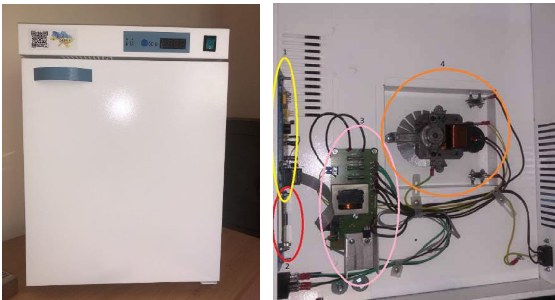
Рис. 3.3. Об'єкт управління – термостат ТС-200 та його вузли
