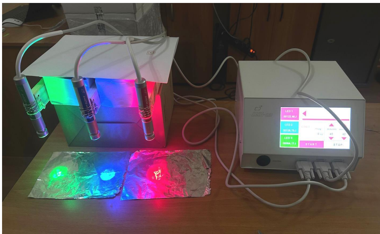
Рис. 1.1. Процес лазерного опромінення насіння на базі приладу Lika-Led
