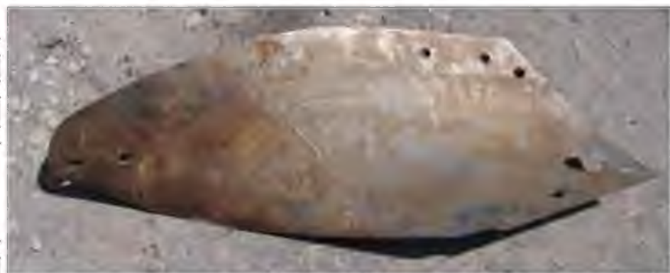
Рис. 1.4 - Наскрізне зношування площини полиці плуга Gregoire Besson
