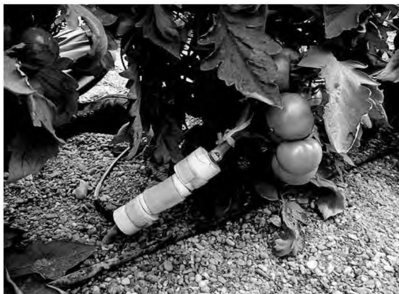
Рис. 3. Датчик водяного потоку, встановлений на стеблі
