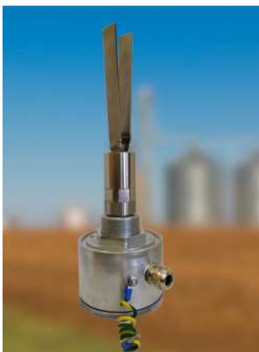
Рис. 3.5. Датчик граничного рівня сипких матеріалів ДПУ-10
