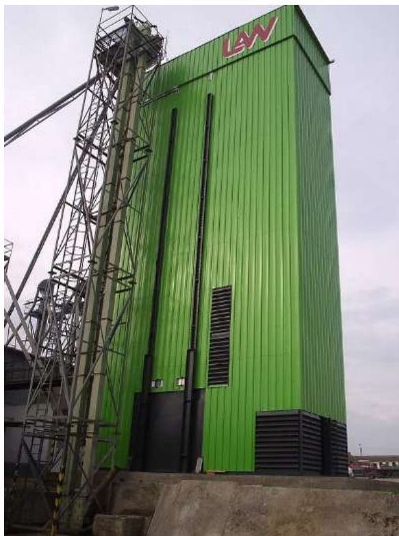
Рис. 1.5. Шахтна зерносушарка LAW типу SBC-LE
