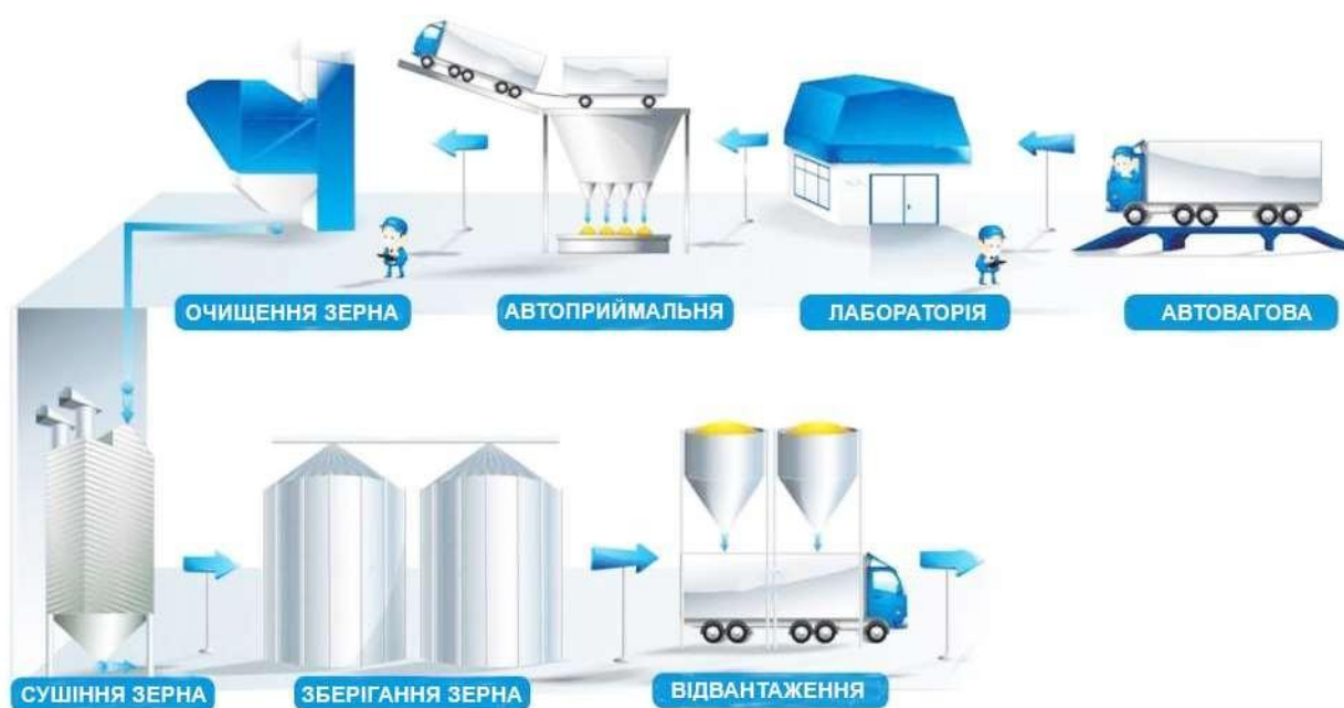
Рис. 1.1. Загальна схема роботи більшості елеваторів
