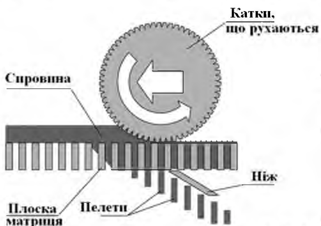
Рис. 2.9. Схема утворення пелет за допомогою плоскої матриці
