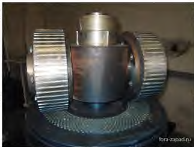
Рис. 2.6. Матриця та робочі ролики (бігунки) прес-гранулятора КЛ-600
