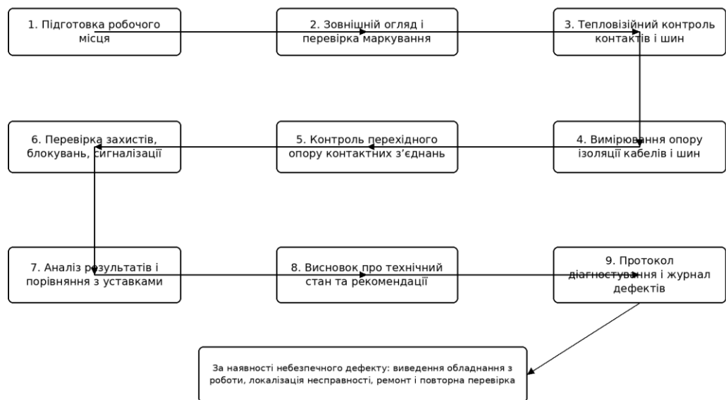
Рис. 1.3. Послідовність діагностування розподільного пункту 0,4 та 10 кВ
