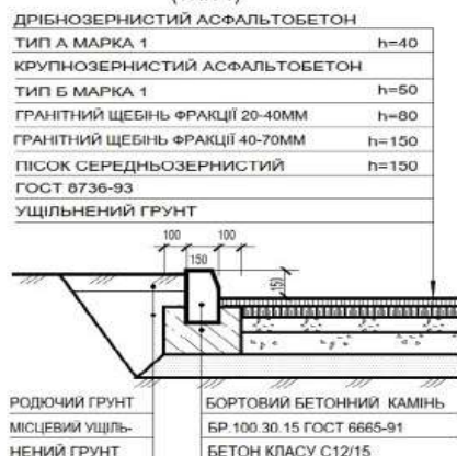
КОНСТРУКЦІЯ АСФАЛЬТОБЕТОННОГО ДОРОЖНЬОГО ПОКРИТТЯ (ТИП 1)
