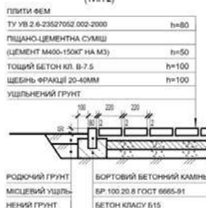
КОНСТРУКЦІЯ ПОКРИТТЯ З ПЛИТ ФЕМ (ТИП 2)
