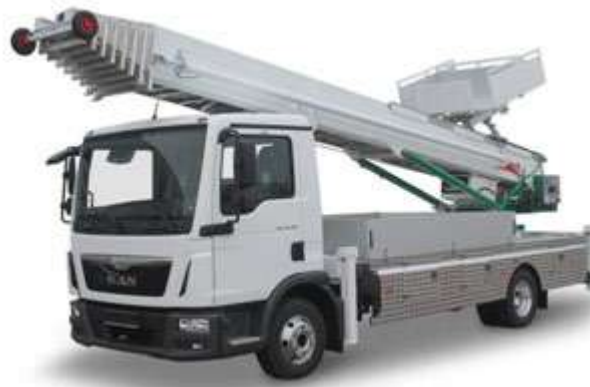
Рис. 5.11. Загальний вигляд автопідйомника Bigmover 45/6.5, технічні характеристики табл. 5.3.
