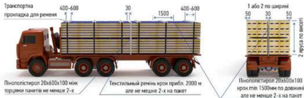
Рис. 8.1. Схема завантаження сендвіч-панелей на автомобіль
