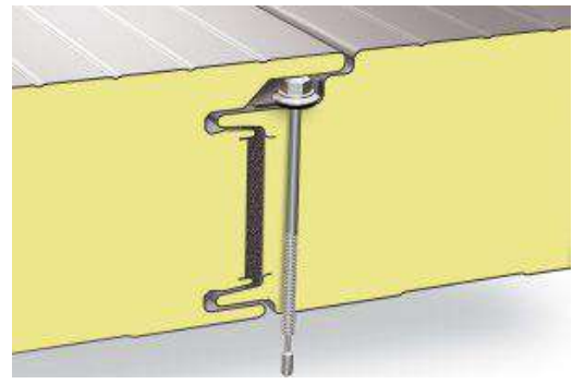
Рис. 1.7. Кріплення сендвч панлей: а) видме; б) прихване
