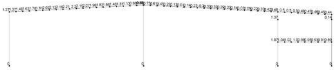
Рис 3.9. Максимальні переїщення по осі Х (голівні балк - повздовжні проїни)
