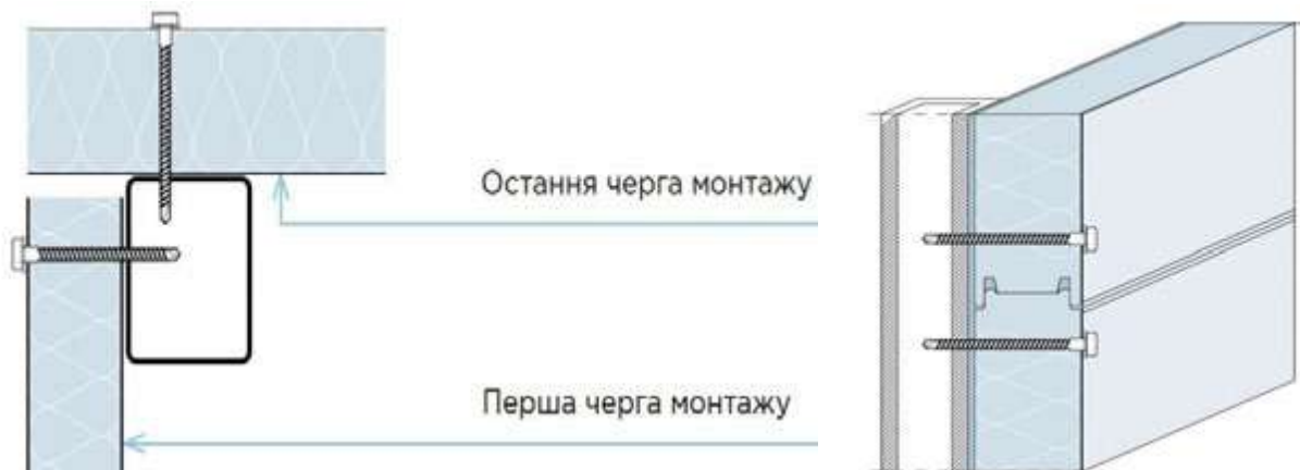
Рис. 5.6. Схематичний порядок монтажу панелей
