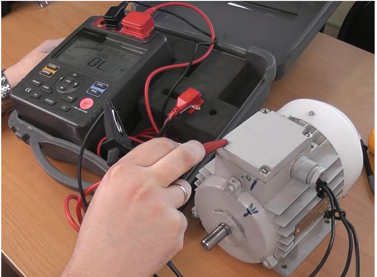
Рис. 4.16. Діагностування електродвигуна цифровим мегомметром UNI-TUT501
