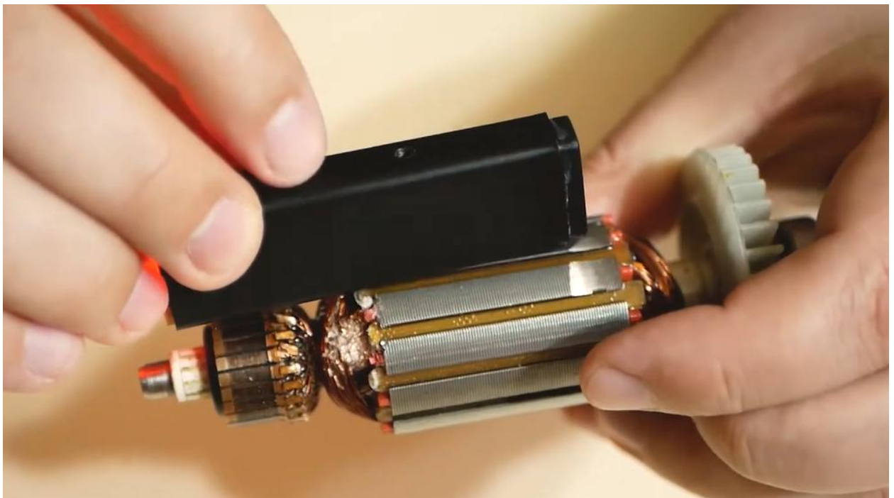
Рис.4.26. Визначення межвиткових замикань електромагнітним індикатором ИРЗ-3
