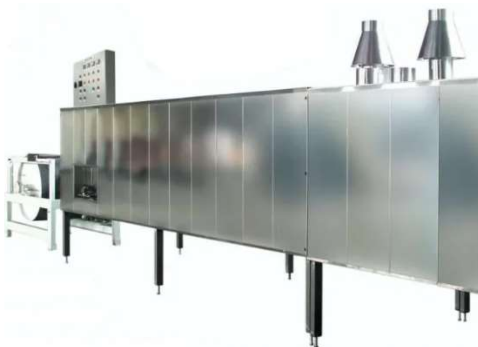
Рис. 1.4. Зовнішній вигляд печі для випікання хлібобулочних виробів типу ПТГ Elcal (Польща)
