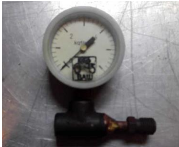
Рисунок 3.6 – Пристосування для вимірювання тиску в паливопідкачувальних магістралях
