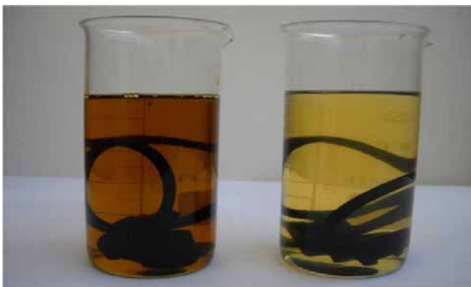
Рисунок 3.10 – Гумотехнічні вироби фільтрів: 1 – у рапсовій олії; 2 – у товарному дизельному паливі
