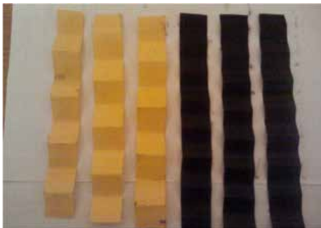
Рисунок 3.8 – Зразки фільтрувального паперу для випробування на розрив
