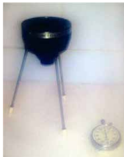
Рисунок 3.4 – Прилади для вимірювання в'язкості та щільності палива
