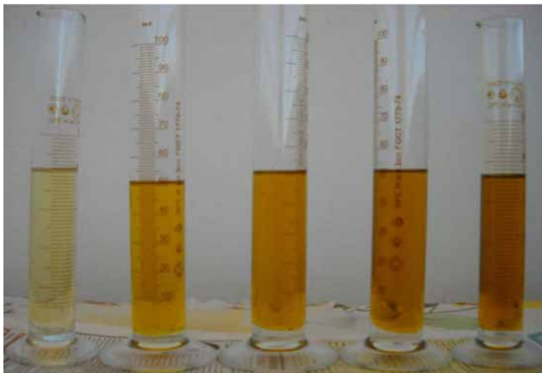
Рисунок 3.3 – Композиції сумішевого палива: №1 (дизельне паливо ДП), №2 (25 % РО: 75 % ДП), №3 (50 % РО: 50 % ДП), №4 (75 % РО: 25 % ДП), №5 (чиста рапсова олія РО)
