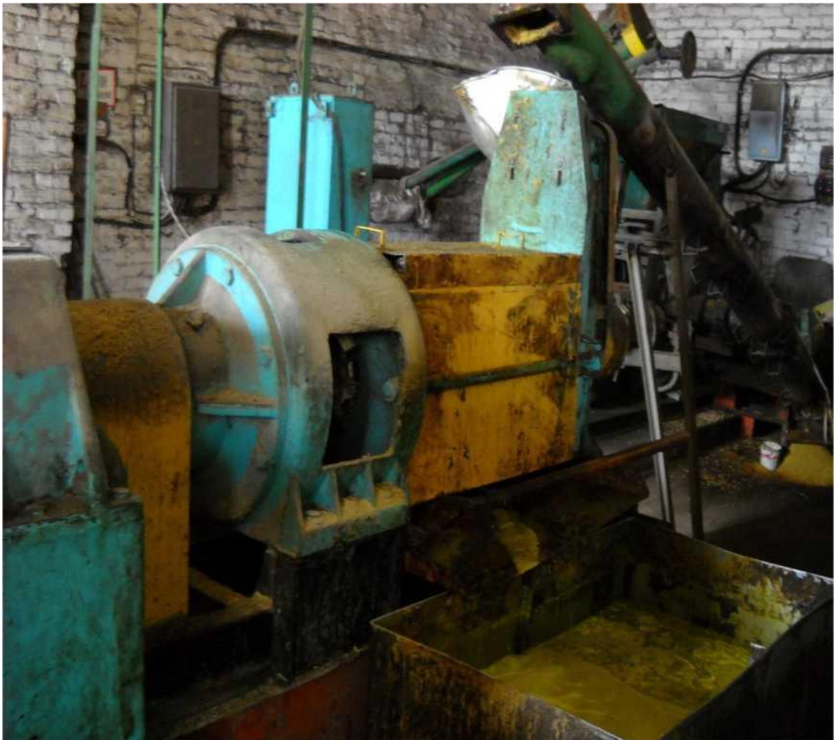
Рисунок 3.2 – Прес-машина 500 для виробництва ріпакової олії
