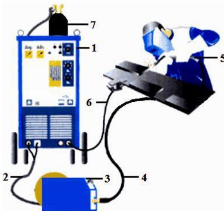
Рис. 3.3. Схема роботи поста наплавлення: 1 - зварювальний напівавтомат; 2 - ланцюг управління; 3 - механізм подачі дроту; 4 - направляючий канал; 5 - пальник; 6 - зворотний провід із затиском; 7 - газовий
