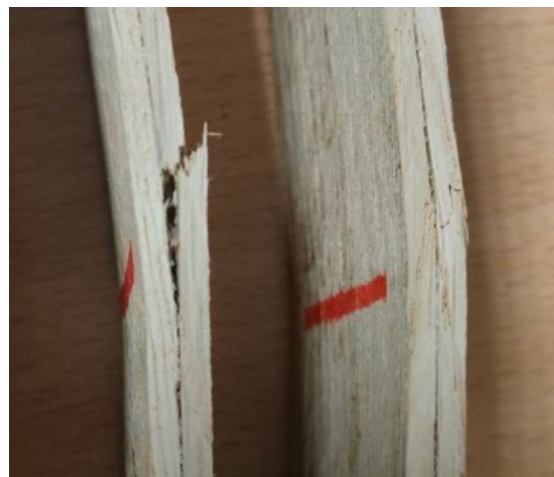
Рис. 3.5. Злам армованих зразків без утворення наскрізного зламу
