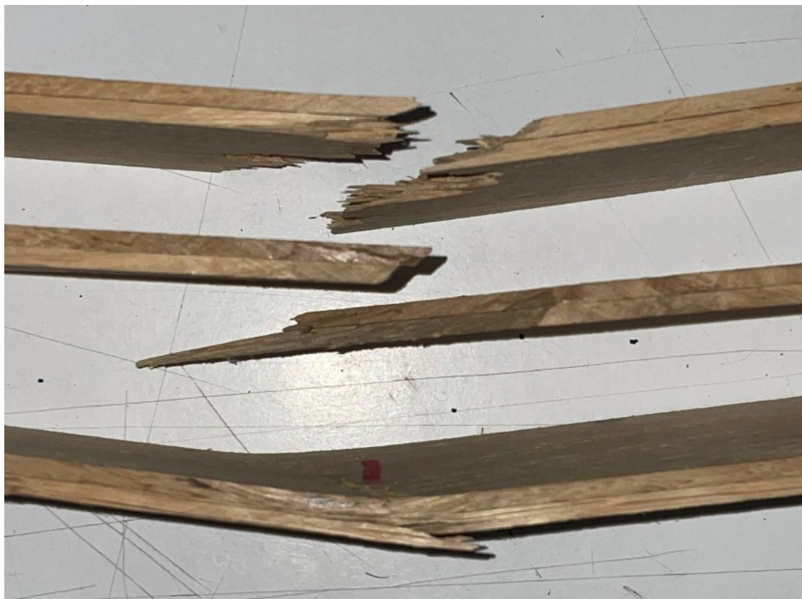
Рис. 3.8. Невідворотна втрата міцності та працездатності неармованих зразків
