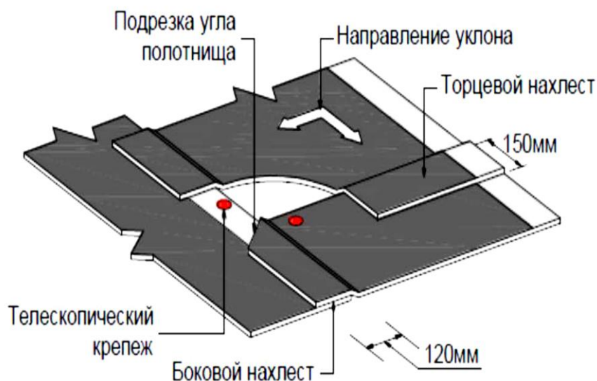
Рис. 5.6. Поздовжнє та торцеве нахльостування суміжних полотнищ мембрани
