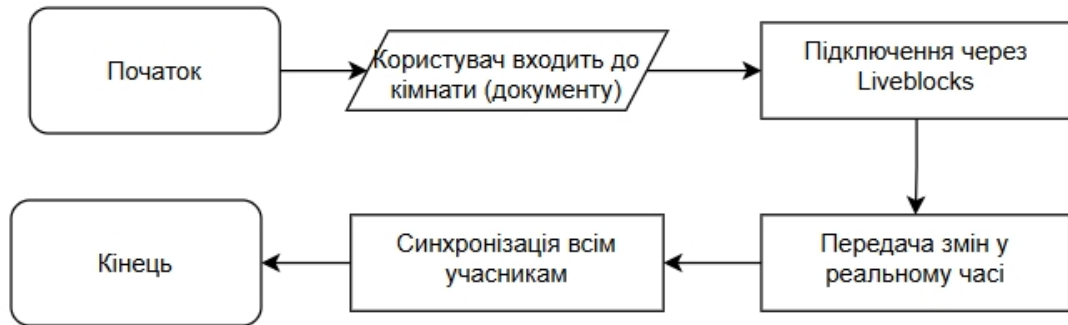
Рис. 3.8. Блок-схема алгоритму спільної роботи над нотаткою
