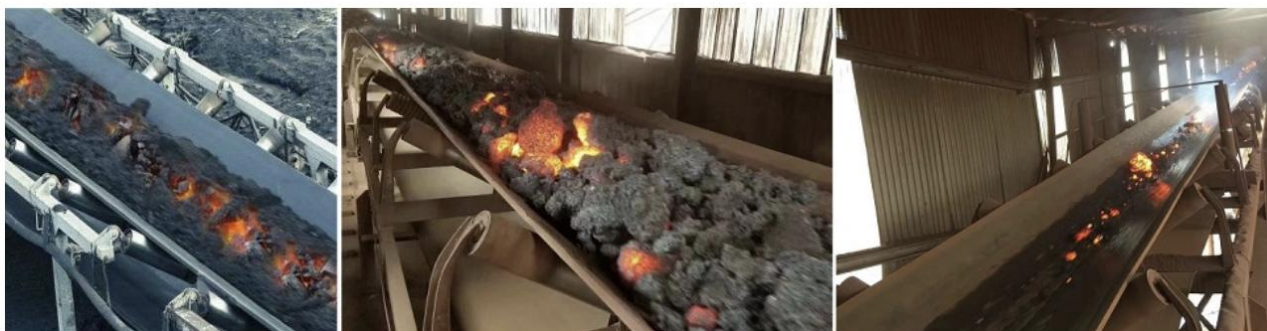
Рис. 1.2. Стрічковий конвеєр з жаростійкою стрічкою
