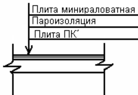
Рисунок 3.4 Схема збору навантажень на плиту горіщну
