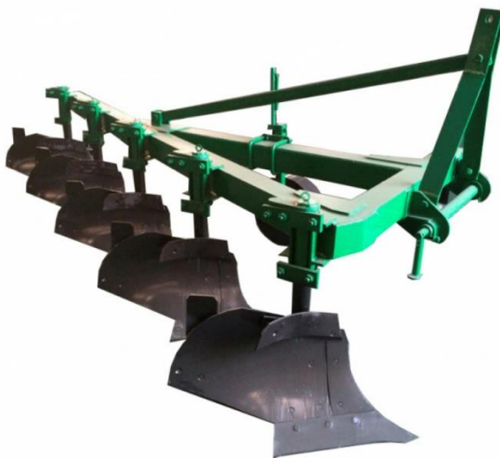
Рис. 2.1.Плуг навісний ПЛН-5-35
