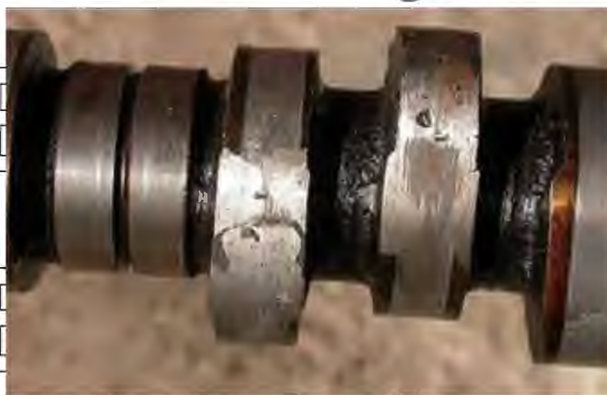
Рис. 2.1. Пошкоджений розподільчий вал
