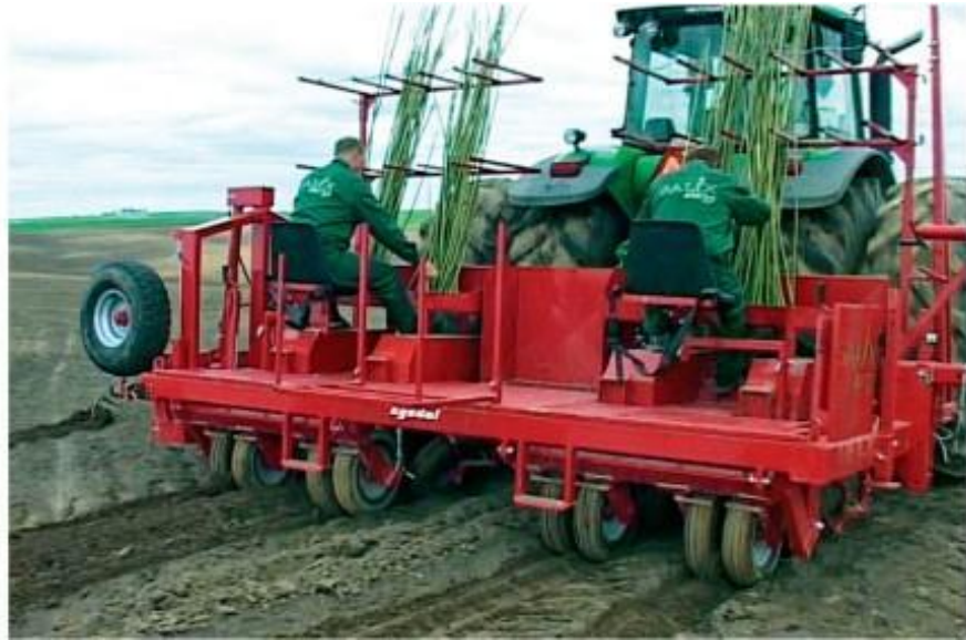
Рис. 2.5. Процес механічної посадки енергетичної верби[50]
