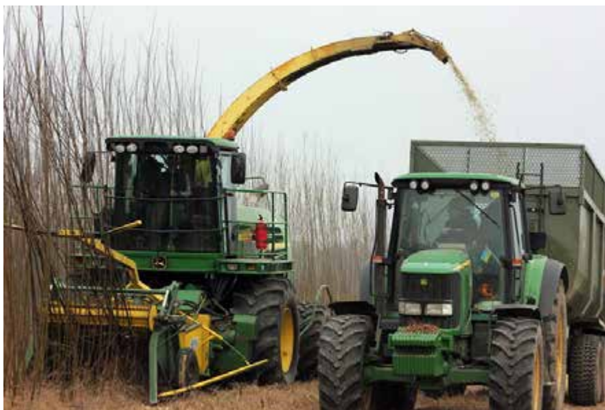
Рис. 2.6. Збирання біомаси верби самохідним комбайном, її подрібнення та перевезення [15]
