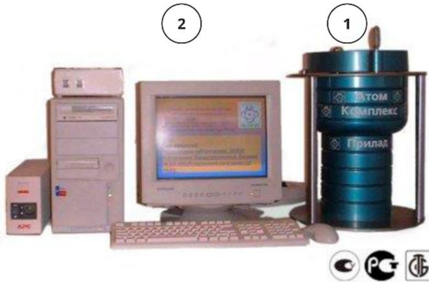
Рисунок 3.5. Вигляд спектрометра СЕГ-001 “АКП”-С. 1 – детектор у свинцевому захисті; 2 – пристрій для реєстрації даних, персональний комп’ютер.
