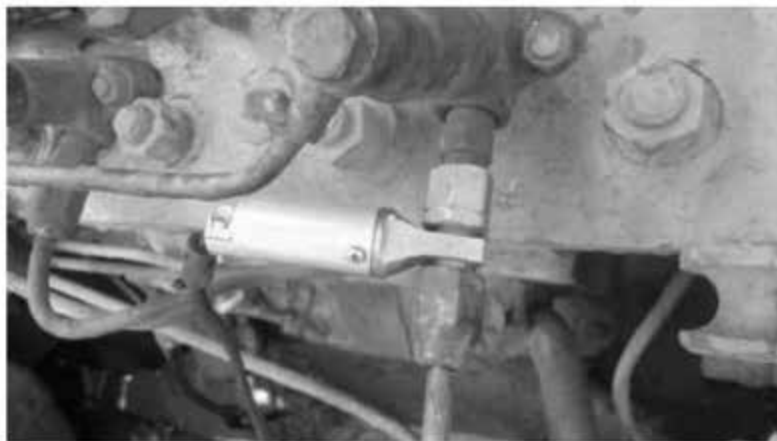
Рисунок 3.12 – Встановлення датчику тиску на паливопроводі високого тиску двигуна СМД-62
