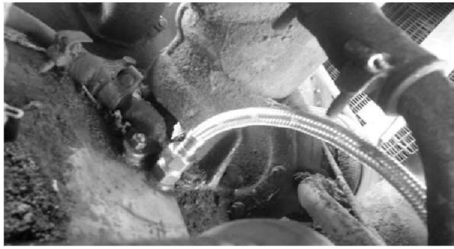
Рисунок 2.11 – Місце встановлення датчика тиску на двигуні СМД-62
