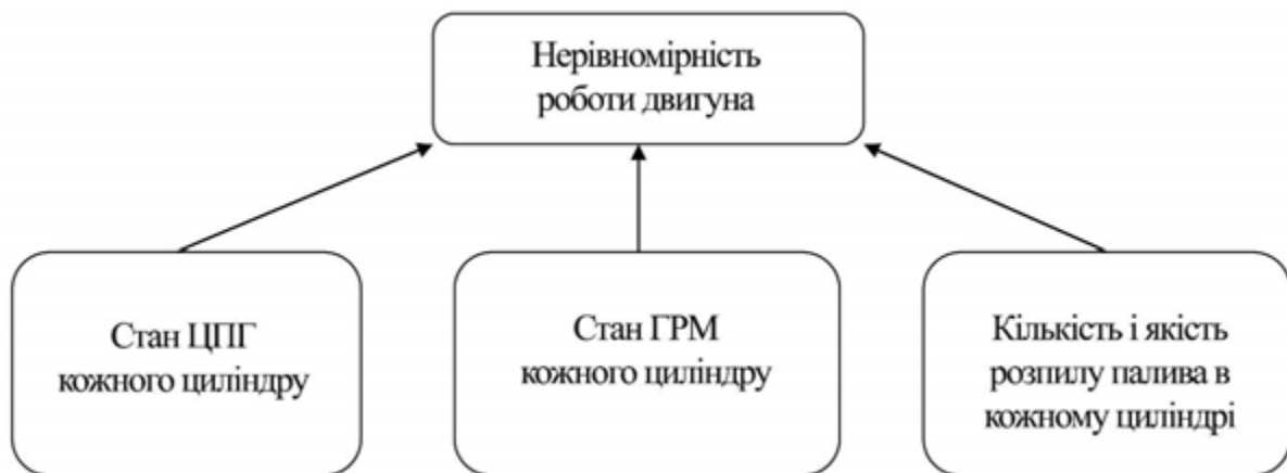
Рисунок 2.15 – Чинники, що впливають на нерівномірність роботи дизеля
