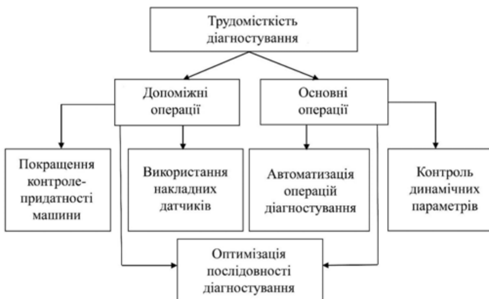
Рисунок 2.1 – Основні шляхи скорочення трудомісткості діагностування
