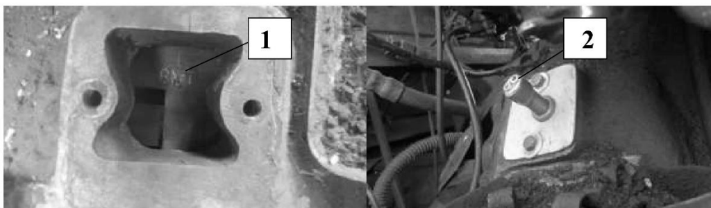
Рисунок 2.5 – Встановлення датчика ВМТ на СМД-62
