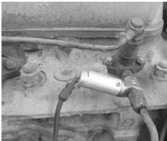
Рисунок 2.6 – Встановлення датчика тиску в паливопроводі
