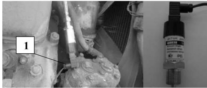
Рисунок 2.7 – Датчик тиску ПД100-Д10.1 та спосіб його встановлення на двигун СМД-62
