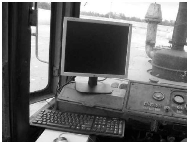
Рисунок 2.12 – Комплекс, що підготовлений для запису показників тиску наддуву
