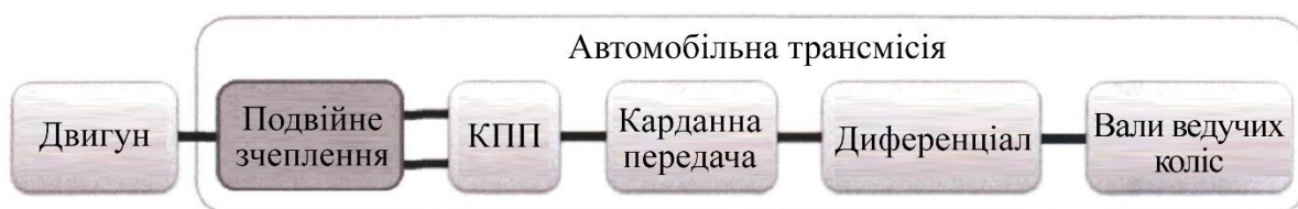
Рисунок 1.1 – Структурна схема автомобільної трансмісії з подвійним зчепленням
