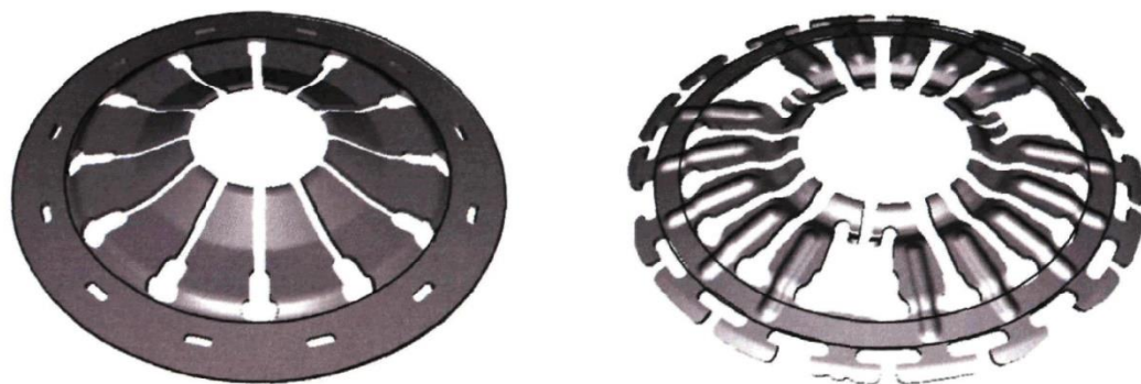
Рисунок 3.5 – Відмінності силових кілець діафрагмових пружин у традиційному та подвійному зчепленнях
