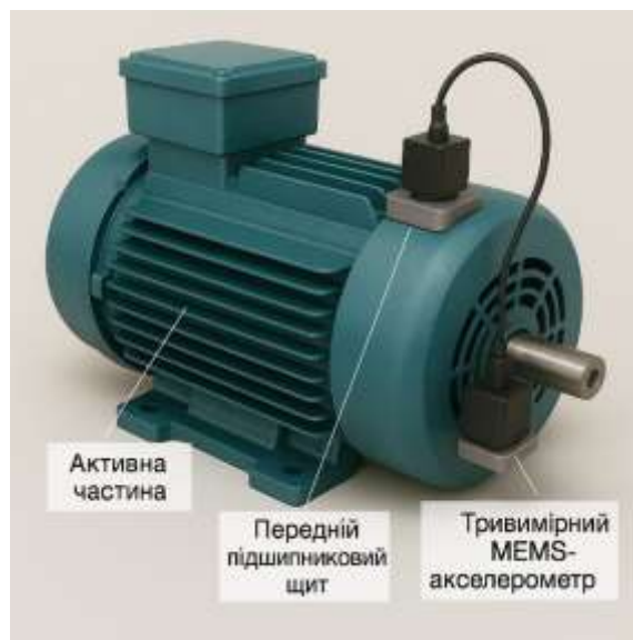
Рис.3.4 розміщення вібраційних датчиків
