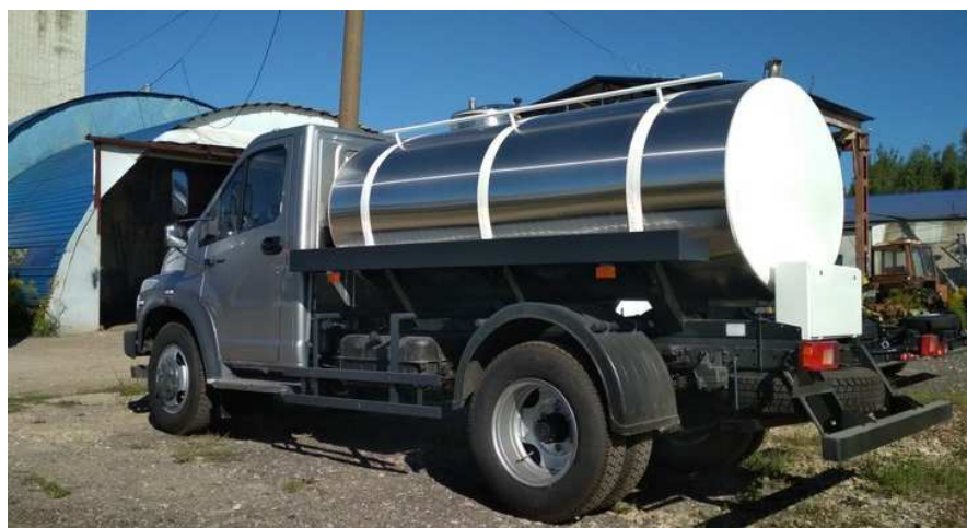
Рисунок 1.10 – Молоковоз на базі ГАЗ-3309
