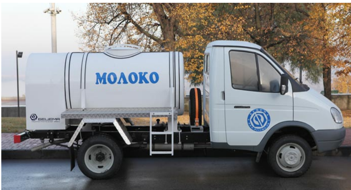
Рисунок 1.6 – Автоцистерна БЦМ-226 для рідких харчових продуктів
