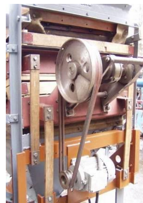
Рис. 3.5. Загальний вигляд вібратора для приводу решітних станів вібропневматичного сепаратора ВПС-5
