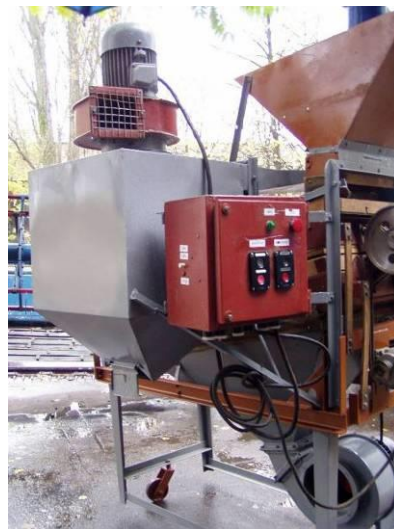
Рис. 3.7. Загальний вигляд всмоктуючого вентилятора з аспіраційною камерою та пультом керування
