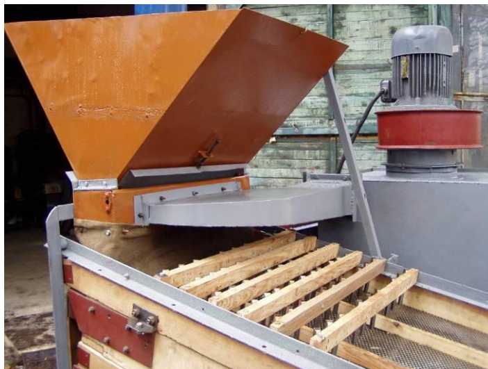
Рис. 3.3. Загальний вигляд розташування пасивних розпушувачів над поверхнею віброрешета
