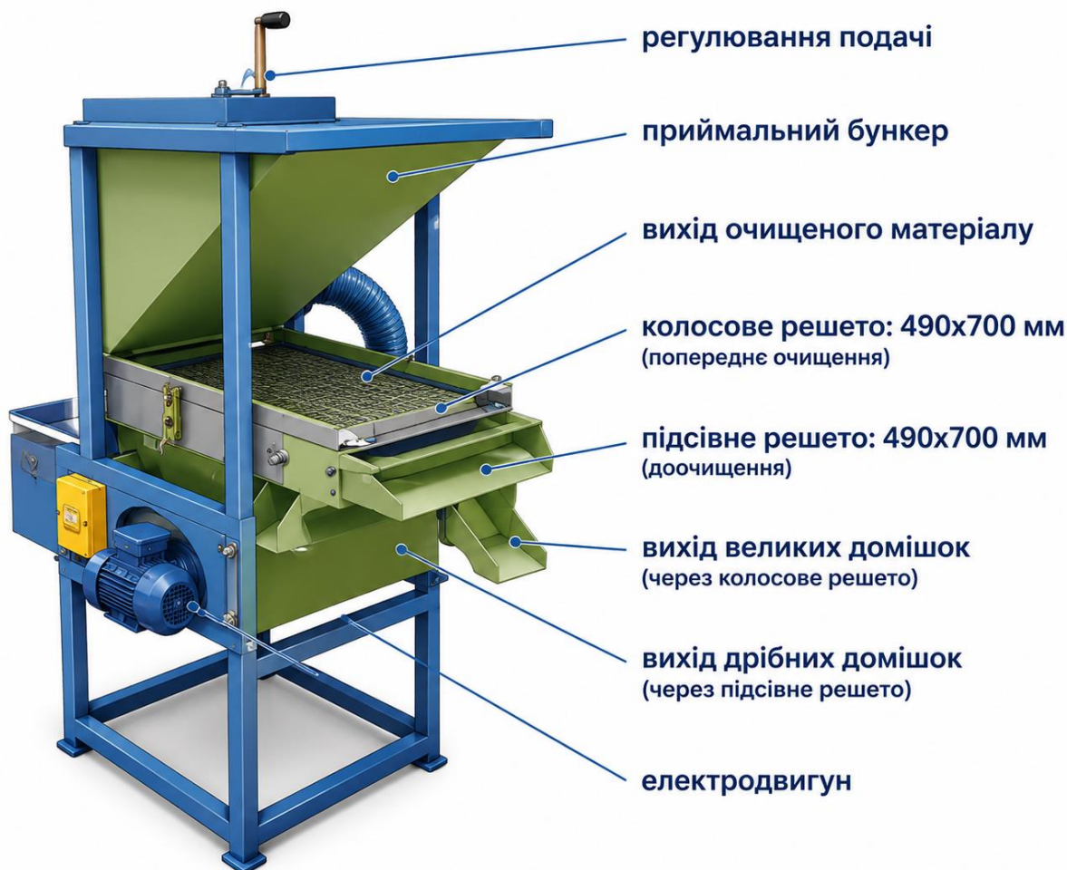
Рис. 1.12. Повітряно-решітний сепаратор
