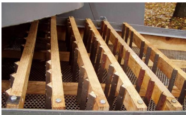
Рис. 3.3. Загальний вигляд розташування пасивних розпушувачів над поверхнею віброрешета
