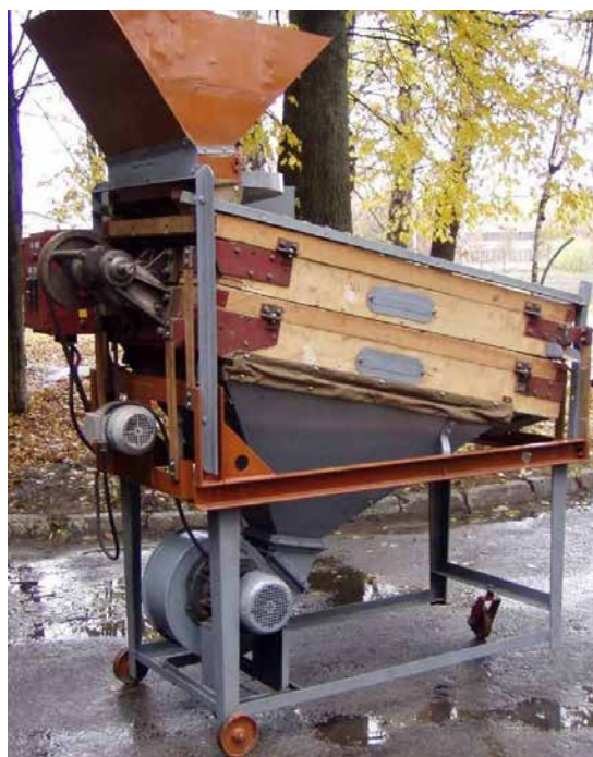
Рис. 3.2. Загальний вигляд дослідного зразка вібропневматичного сепаратора для зерна і насіння ВПС-5 [33]
