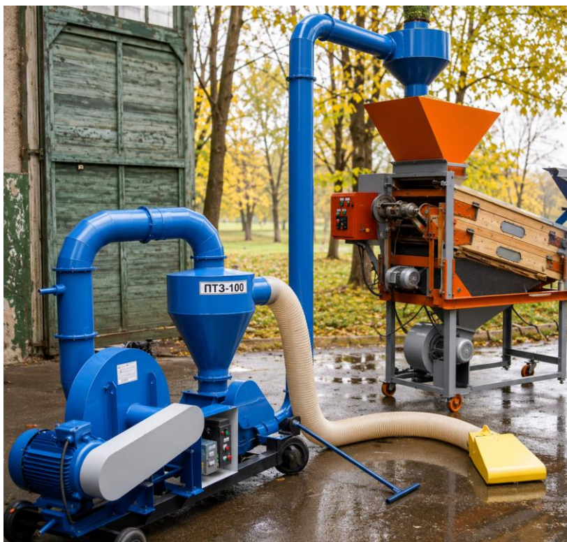
Рис. 3.1. Завантаження дослідного зразка вібропневматичного сепаратора ВПС-5 пневматичним навантажувачем зерна ПТЗ-100
