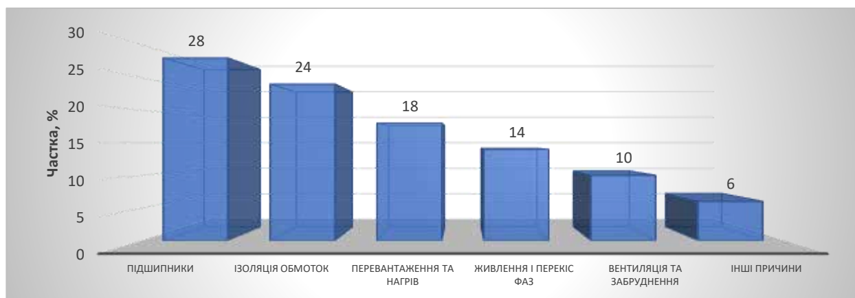
Рис. 1.1 – Орієнтовна структура причин відмов асинхронних двигунів потужністю до 11 кВт
