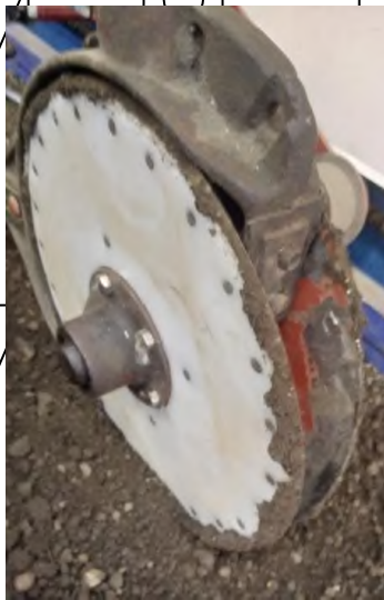
Рис. 4.6. Налипання ґрунту на диски широкорядного (однорядкового) дводискового сошника при випробуваннях у ґрунтовому каналі при вологості ґрунту 15%: а) – модернізований, б) – стандартний
