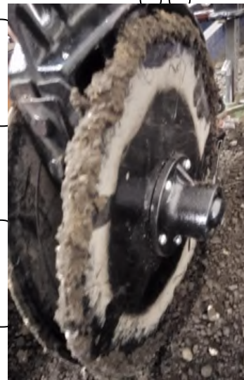
Рис. 4.6. Налипання ґрунту на диски широкорядного (однорядкового) дводискового сошника при випробуваннях у ґрунтовому каналі при вологості ґрунту 15%: а) – модернізований, б) – стандартний
