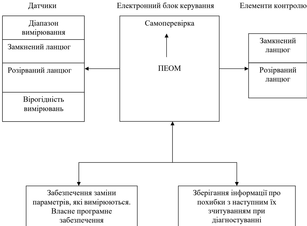
Рисунок 1.2 – Функції бортової системи діагностування
