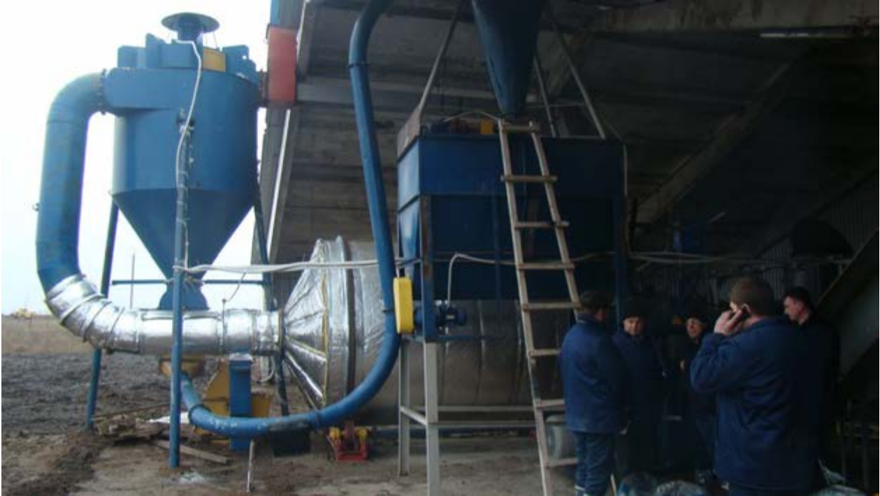
Дослідна установка для сушіння і гранулювання свинячого гною з утворенням паливних пілет
