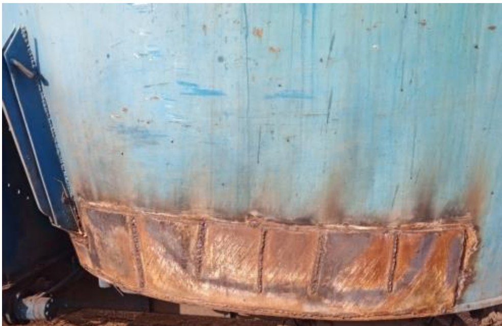
Рис. 2. Відновлена стінка бункера
