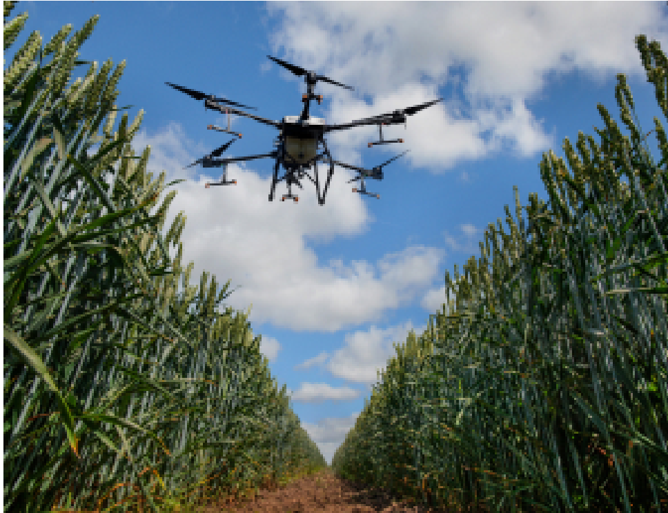
Рис. 1.3. Внесення добрив повітряними ДБКА (дронами). Джерело: [5]
