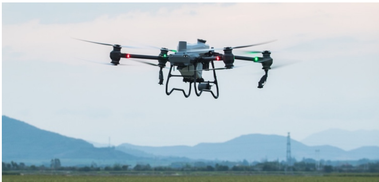
Рис. 4.17. Використання БПЛА для внесення пестицидів.
