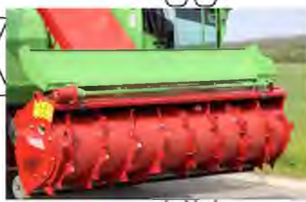
Рис. 4.6. Фрезерний агрегат самохідного кормозмішувача Verti-Mix SF
