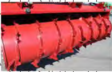
Рис. 4.7. Високопродуктивна фреза самохідного кормозмішувача Verti-Mix SF
