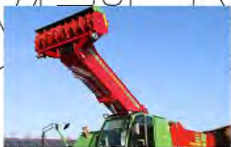
Рис. 4.6. Фрезерний агрегат самохідного кормозмішувача Verti-Mix SF
