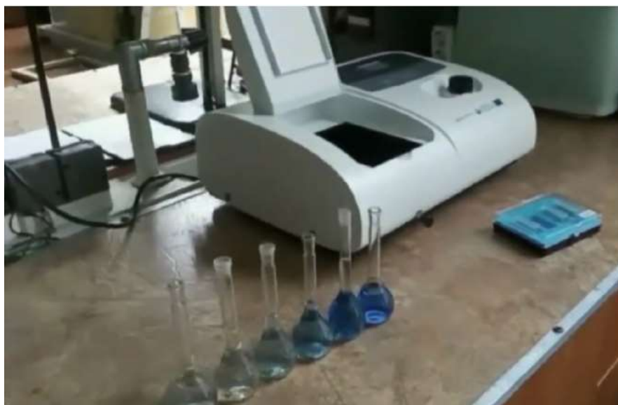
Рис.3.3.4 Приклад підготовки Приклад підготовки калібрувальних розчинів для спектрофотометричного визначання вмісту нітратів:
