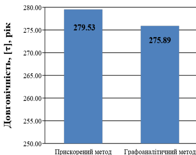
Рис. 5. Довговічність ламінованої стружкової плити товщиною 16 мм при \sigma=5 Мпа, температурі T=293 К
