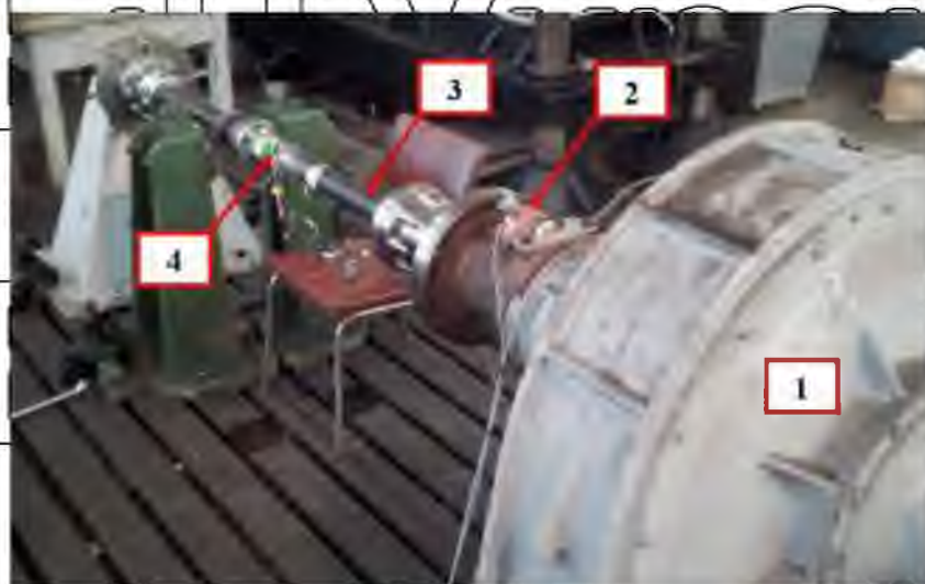
Рисунок 3.8 – Гарування показань тензопідсилювача телеметричного ТТ01: 1 - планетарний редуктор, що навантажує; 2 - датчик крутного моменту стенду; 3 – задній карданний вал; 4 - тензопідсилювач телеметричний ТТ01
