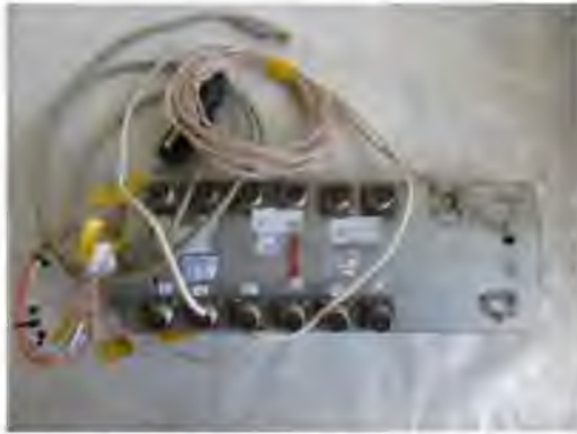
Рисунок 3.11 – Реєструвальна апаратура: 1 – АЦПL-Sara E14 440; 2 – ПЦП
