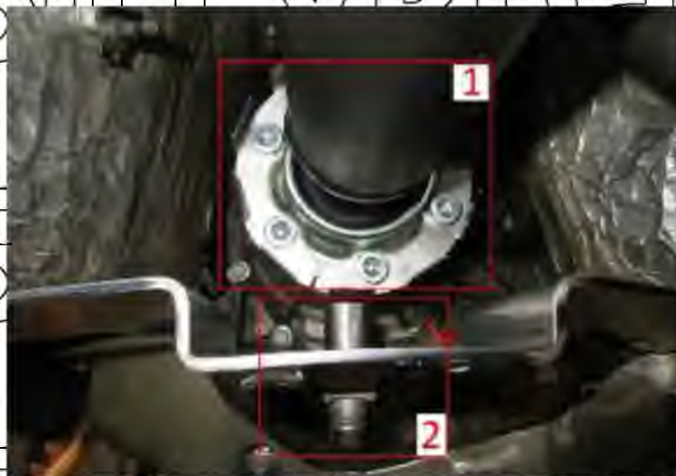
Рисунок 3.10 – Розміщення датчика швидкості в універсальній частині трансмісії: 1 - металева гребінка; 2 - датчик пульсу IC-445
