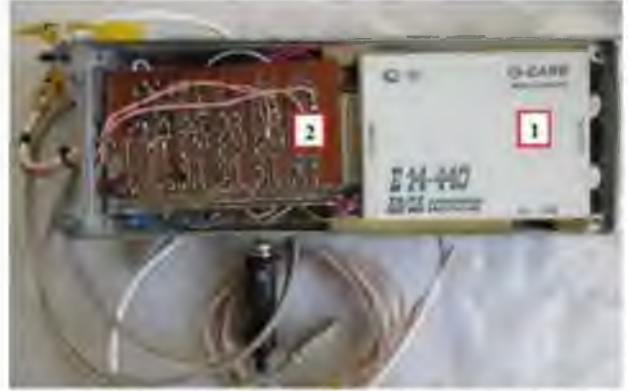
Рисунок 3.11 – Реєструвальна апаратура: 1 – АЦПL-Sara E14 440; 2 – ПЦП
