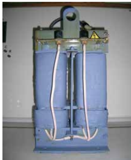
Рис. 3.7. Високовольтний трансформатор сухий ОСВ-1,5 220/15000
