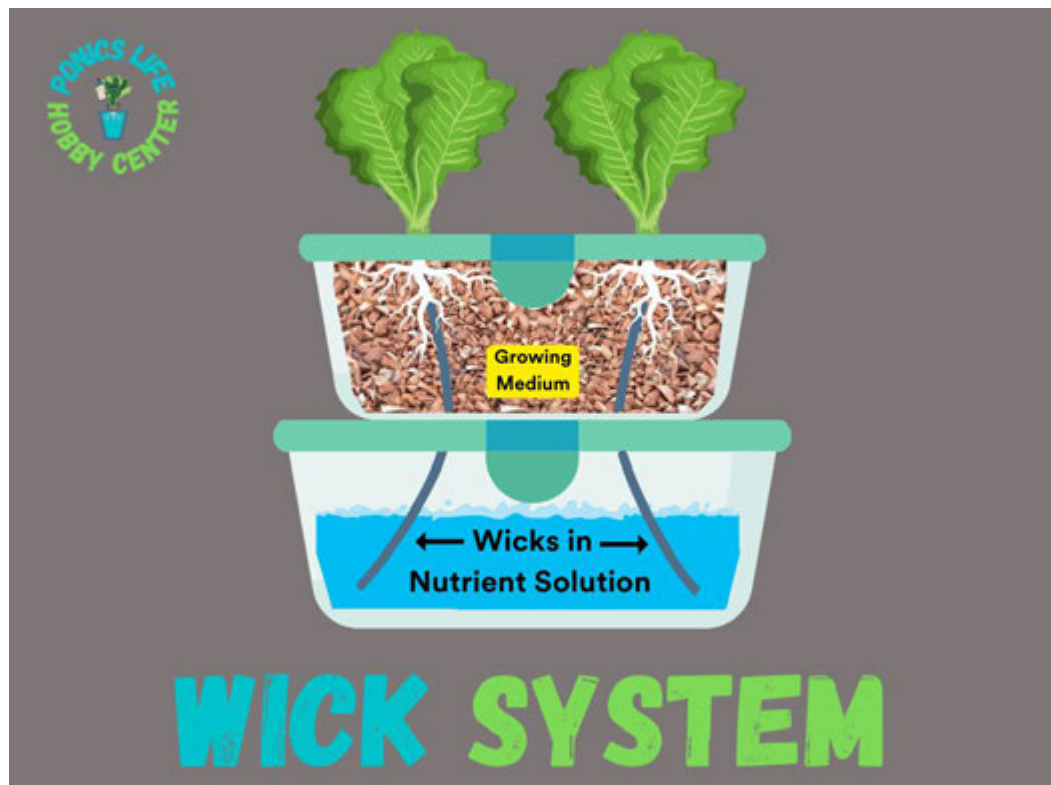
Рисунок 1.1 Схема гнітової системи
