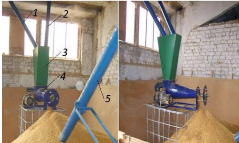
Рисунок 4.3 - Спіральний змішувач у лінії гранулювання:
