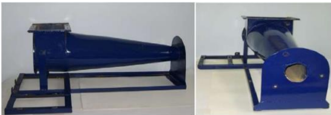
Рисунок 3.20 - Корпус макета спірального змішувача
