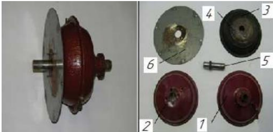
Рисунок 3.16 – Мембранний насос ЗКЕ
