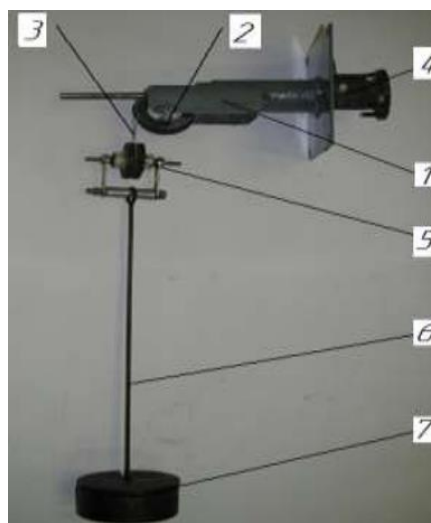
Рисунок 3.17 - Поворотний механізм шнеково-лопатевого змішувача
