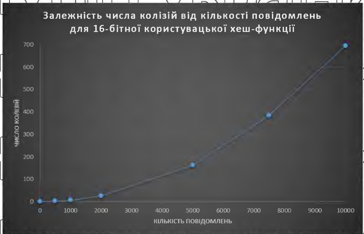
Рис.3.20 – залежність числа колізій в 16-бітовому варіанті створеної хеш-функції (user) від кількості вхідних тестових повідомлень
