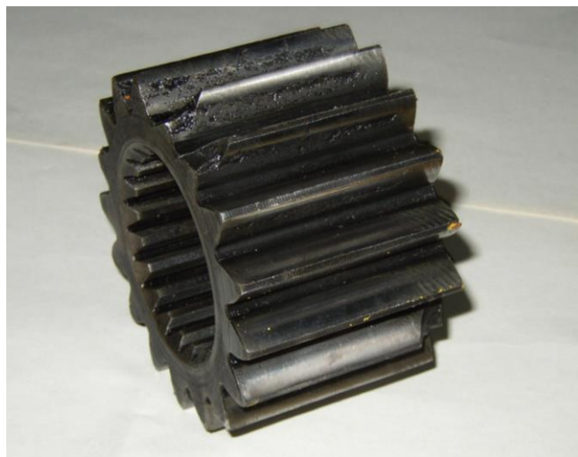
Рисунок 3.9 – Сонячна шестерня яка відробила на тракторі ХТЗ-17021 6900 мотогодин.
