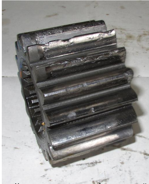
Рисунок 3.8 – Типовий вигляд шестерні сонячної після випробувань
