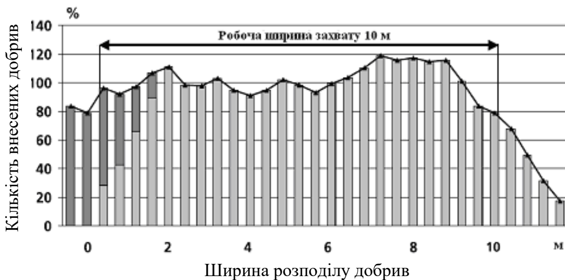
Рис. 1.12. Гістограма розподілу добрив горизонтально розташованими робочими органами розкидача для бокового внесення Gafner 5.5 A-Vario з нормою внесення 25 т/га
