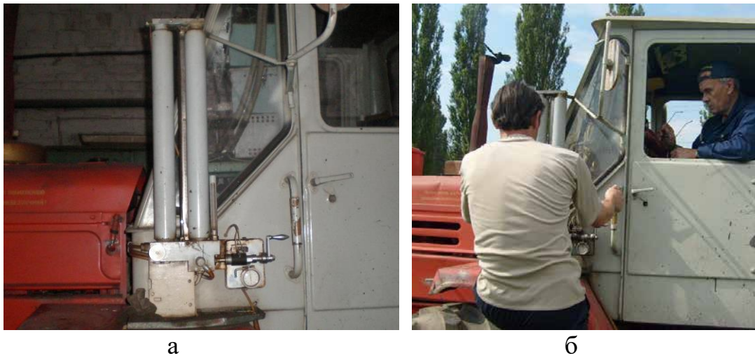
Рис. 2.9 - Загальний вигляд витратоміра пального (а) та процес зняття показників (б)
