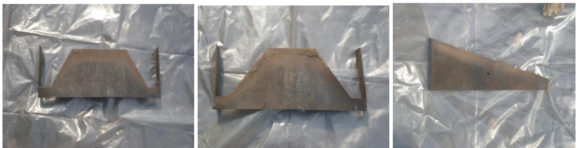
Рис. 2.3. Загальний вигляд змінних лопаток робочого органу
