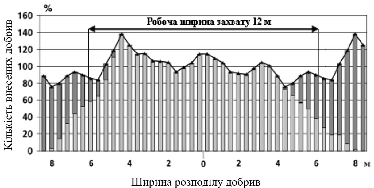
Рис. 1.10. Гістограма розподілу добрив дисковими робочими органами розкидача Jeantil EP 2060 Erandor-3 з нормою внесення 25 т/га
