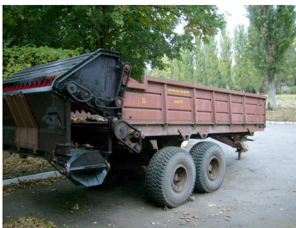
Рис. 2.5. Експериментальний зразок навісного модуля з боковим викидом на базі ПРТ-10-1
