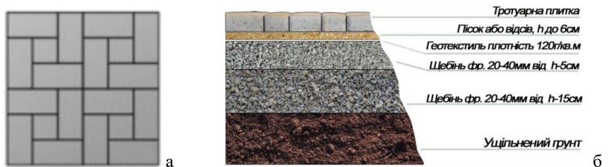
Рис. 4.2. Схема вкладання тротуарної плитки (а) [23] та конструктивний розріз шарів (б) [22]
