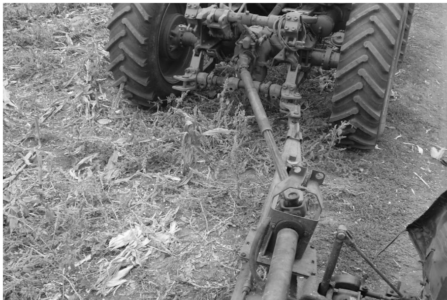
Рисунок 3.3. Асиметричне приєднання КСС-2,6 до трактора ХТЗ-160.
