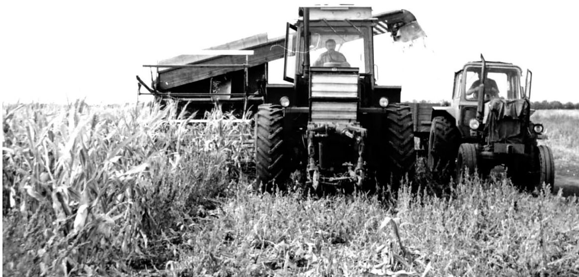
Рисунок 3.1. Силосозбиральний агрегат в роботі (агрегатування комбайна КСС-2,6 з трактором ХТЗ-160)
