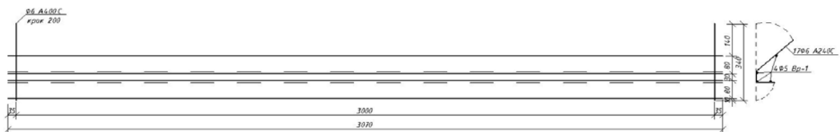
Рис. 2.23. Армование консольной балки сходового маршу
