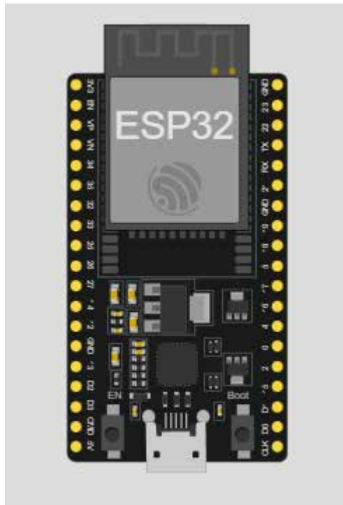
Рисунок 2.3 - Апаратна основа контролера-шлюзу на базі ESP32
