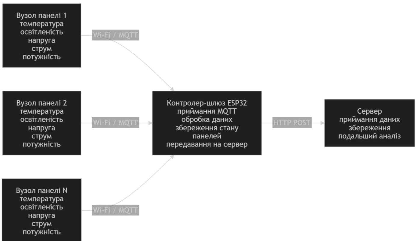
Рисунок 2.1 - Структурна схема системи моніторингу панелей у СЕС
